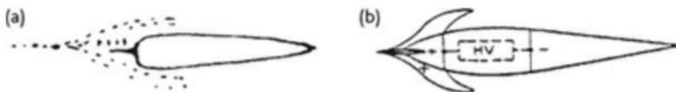
图 5.2. (a)碟形飞机带电前缘周围气流的静电偏转。(来自罗斯, “飞碟”, 社会研究大学, 1952 年 4 月 8 日, 第 7 卷), (b) 布朗建议在火箭的船头使用高压针电极。(来自美国布朗专利 3022430, 图 2)
