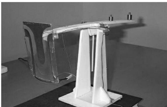
图 12.15.由让-路易斯·诺丁进行的拉弗格推进器试验。(照片由 J.-L.Naudin 提供，来自他的网站，<http://jnaudin.free.fr/>)
