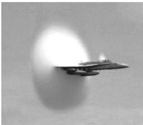
图 5.8. 一架以跨音速飞行的 F/A-18 喷气式战斗机周围的蒸汽云。(美国海军少尉约翰·盖伊摄)
