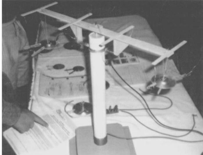
图12.6. 拉里·迪文波特为复制托马斯·汤森·布朗的电动圆盘实验而建立的小型旋转电动圆盘装置。（图片由L.迪文波特提供）
