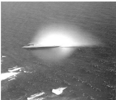
图 5.7. 一架 B-2 轰炸机以跨音速速度在潮湿的沿海空气中飞行，其弓形压缩波后面凝结着蒸汽云。(波比·加西亚摄影，美国空军飞行测试中心提供)
