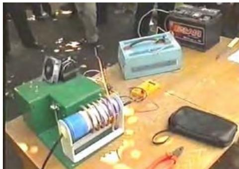
这里显示了主要的操作组件，放置在一个小桌子上。有一个铅酸电池（在后面的演示中被移除），它看起来是一个逆变器，从电池中产生主交流电压，出于安全原因，一个高压升压系统安装在一个绿色的盒子里，一个特斯拉线圈，一个安装在盒子上的火花间隙和一个风
