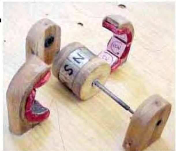
Una vista esquemática muestra la armadura, estator y bloques de madera listos a reunirse en un alternador
