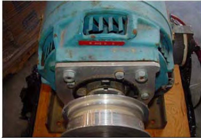
Kundenspezifische Adapter Flansch hinzugefügt, um die Vorderseite des Motor
